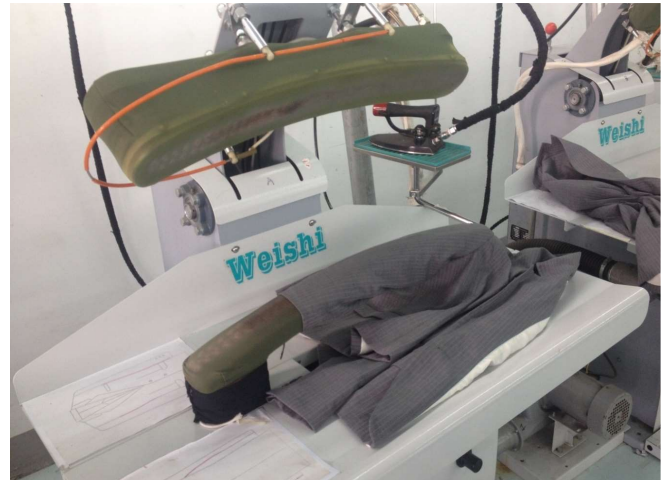
立体プレス設備
